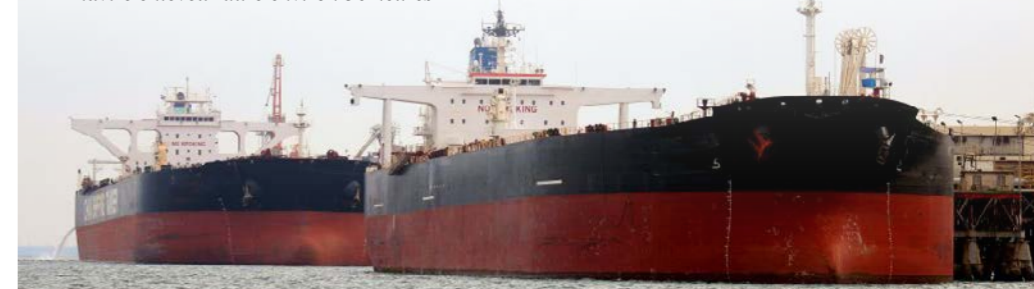
Le transfert d'une cargaison du stokeur au navire enleveur dure environ 36 heures
