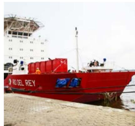
Elle a été carénée entre le 28 janvier et le 1<sup>er</sup> mars, au chantier naval de la Compagnie abidjanaise de réparations navales (CARENA). Pour ce faire, la barge a été sortie de l'eau et mise en cale sèche. Ce carénage était prévu après 10 ans d'exploitation.
